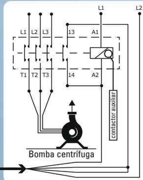
**Ejemplo de conexión eléctrica a un contactor**
